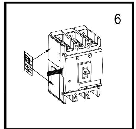
4. 將內部附屬品壓入斷路器，直至聽到卡嗒一聲。(欠電壓跳脫裝置的外部模塊安裝在斷路器上蓋側面卡槽上)請不要在斷路器ON、OFF位置安裝內部附屬品，否則有可能會導致內部附屬品不能正常工作或損壞。
