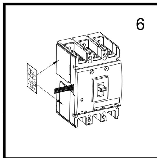
4. 將內部附屬品壓入斷路器，直至聽到卡嚓一聲。(欠電壓跳脫裝置的外部模塊安裝在斷路器上蓋側面卡槽上)請不要在斷路器ON、OFF位置安裝內部附屬品，否則有可能會導致內部附屬品不能正常工作或損壞。
